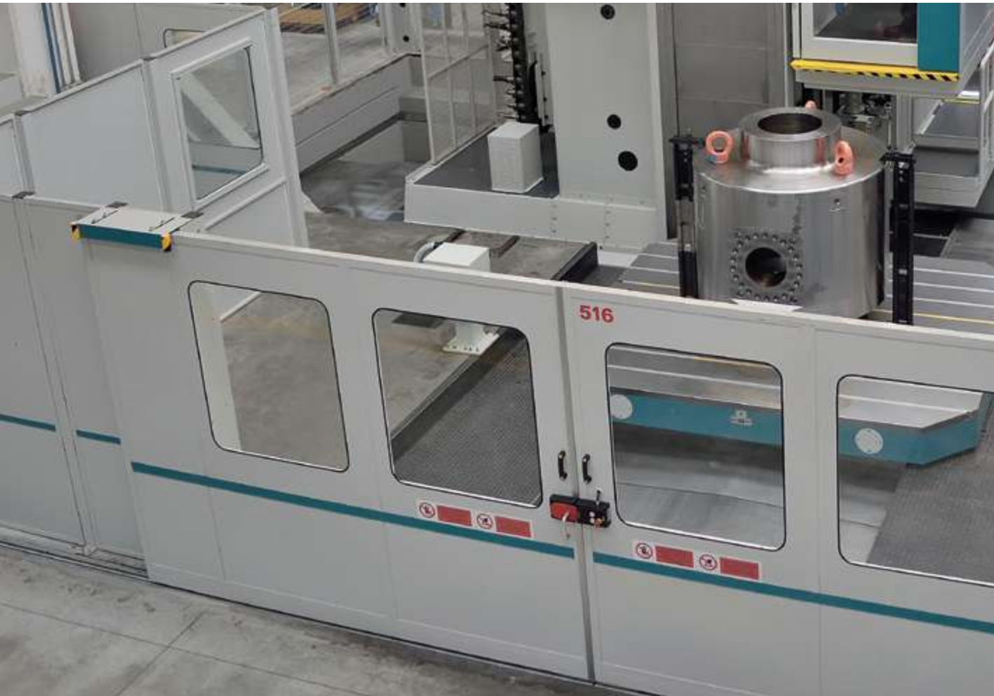
Ejemplo de aplicación de una protección estanca de contención de virutas.
