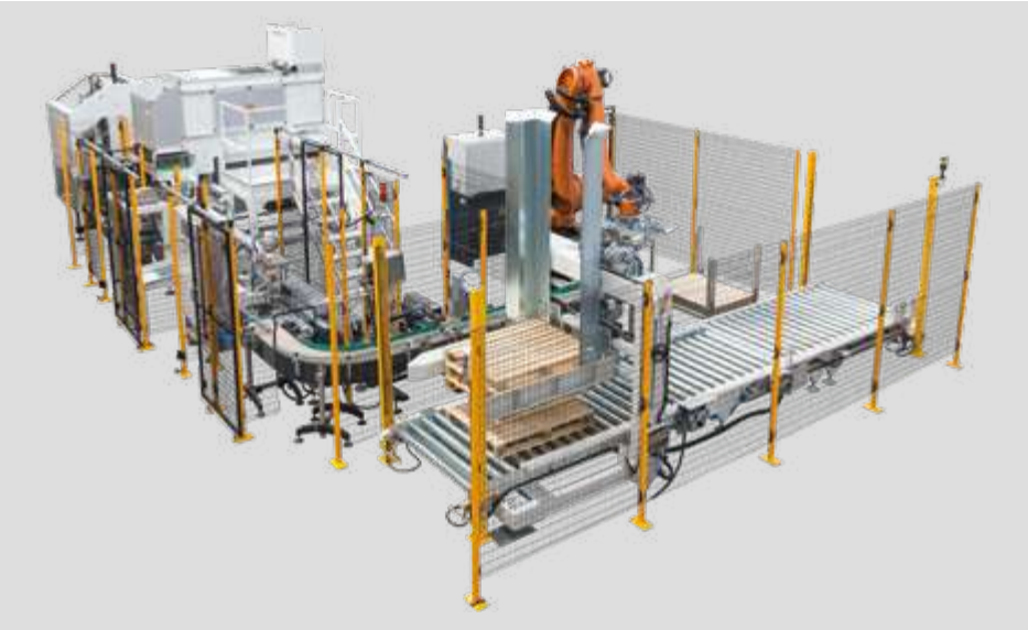
Ejemplo de aplicaciones del sistema Techno para la delimitación de zonas con maquinaria peligrosa.
