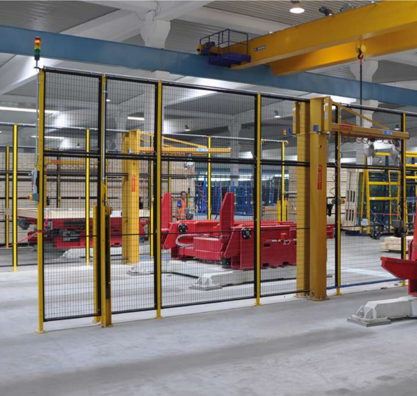
Ejemplo de aplicación del sistema Novatek para la delimitación de zonas con manipulación de cargas a gran altura.
