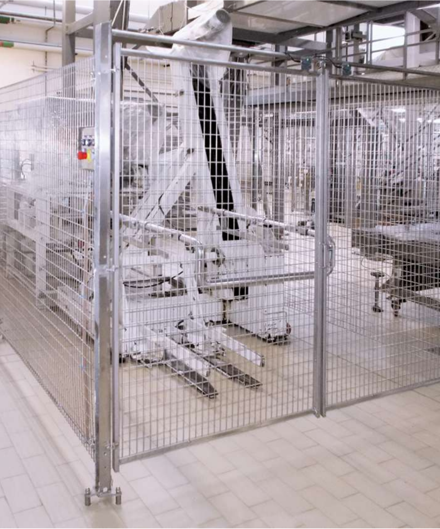
Ejemplo de aplicaciones del sistema Food Inox para la delimitación de zonas con maquinaria peligrosa en el entorno alimentario.
