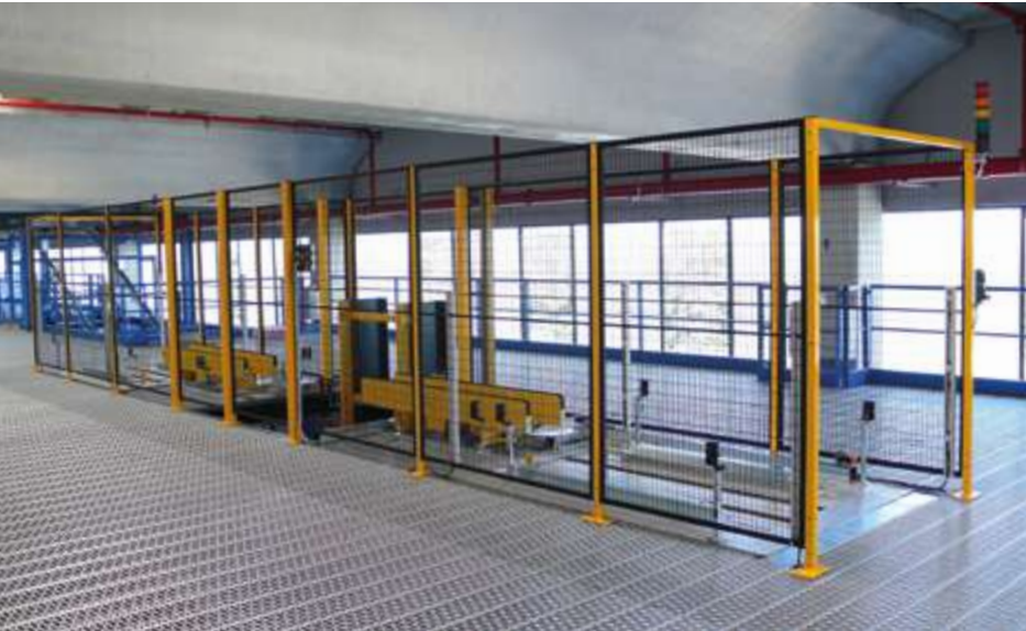
Ejemplo de aplicaciones del sistema Novatek para la delimitación de zonas con maquinaria peligrosa.
